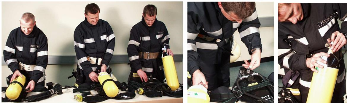
Abb. 30: Flaschenwechsel, Kontrolle der O-Ringe und Ventile
