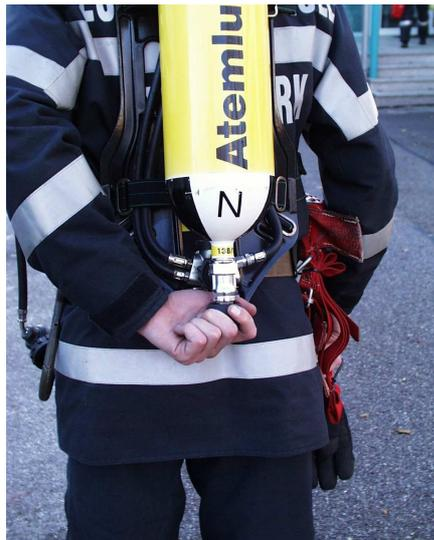
Abb. 3: Öffnen der Flaschenventile
