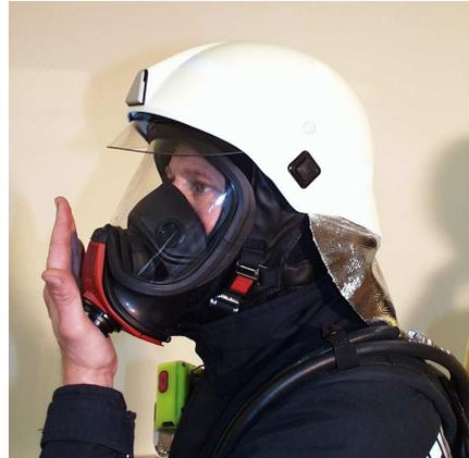
**Abb. 7: Maskendichtprüfung nach Aufsetzen des Helmes**
