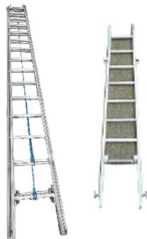
Dient zum Überwinden von Höhen und Tiefen. Es gibt Schiebeleitern, Steckleitern-, Teleskopleitern, Anhängleitern-, und Drehleitern.
