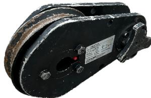
Dient zum Umlenken bzw. zur Änderung der Richtung eines Seiles. Wird mit einem Anschlagmittel wie z.B. einem Schäkel oder einer Schlinge befestigt.
