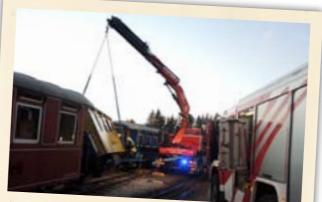
19.10.2014: Ein Waggon des "Stainzer Flascherlzuges" war bei Verschubarbeiten entgleist. Die Feuerwehr Stainz konnte den Waggon mittels Kran und Seilwind zurück auf die Gleise heben. Verletzt wurde niemand.
