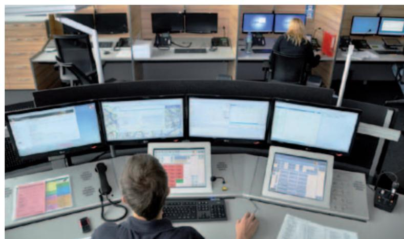
Das ELS ist auf drei Monitore aufgeteilt. Einem Kartenmonitor, einem Monitor mit der Einsatzhauptmaske, dem Einsatzmonitor mit Zusatzinformationen.
